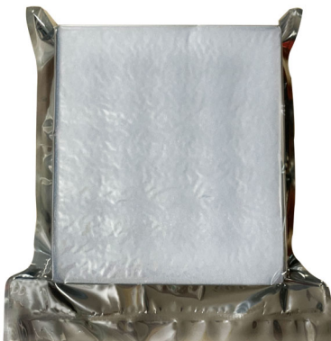
Sele a bandeja com um saco antiestático
